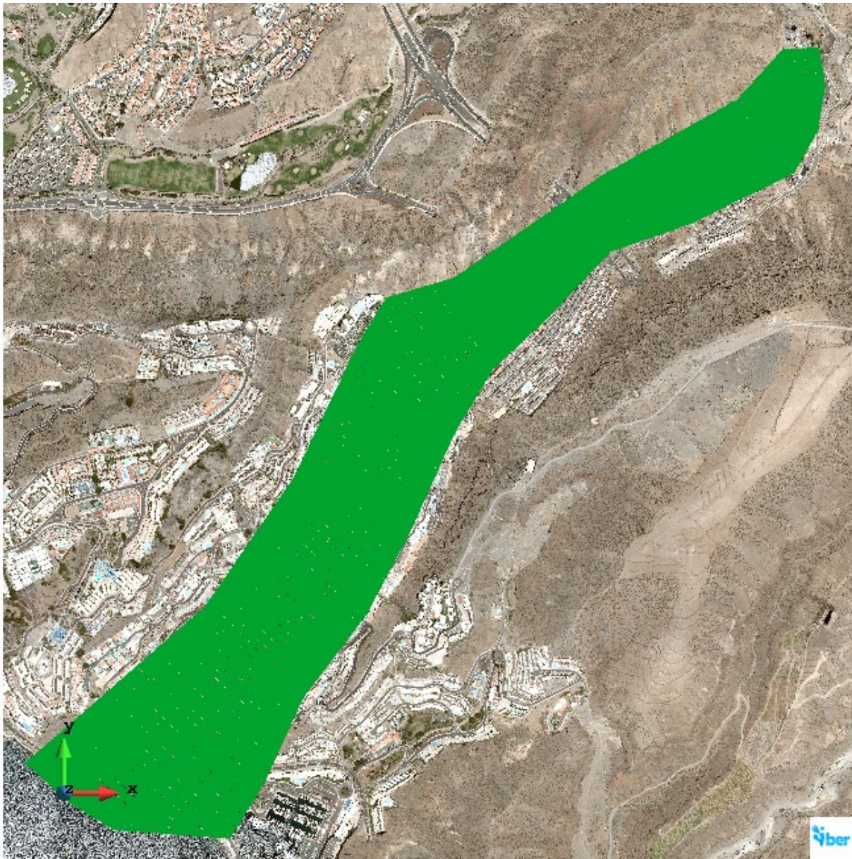
Figura 40. Malla de cálculo utilizada en Iber para el barranco de Puerto Rico.
