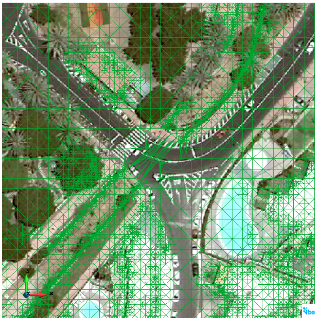
Figura 44. Detalle de la malla en la zona del puente 6.
